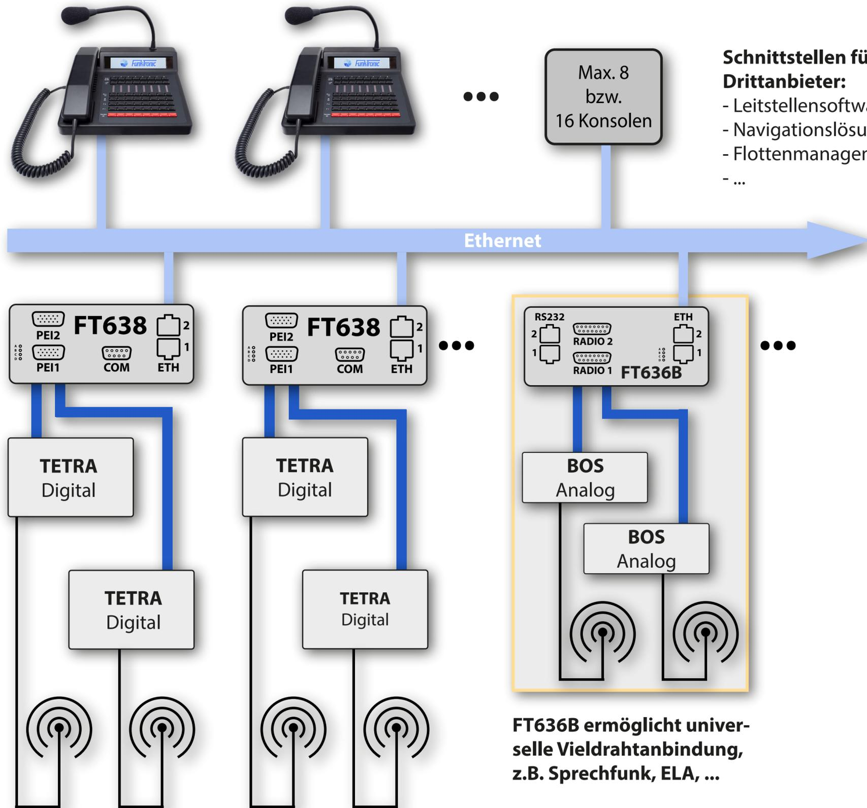
**FT636B ermöglicht universelle Vieldrahtanbindung, z.B. Sprechfunk, ELA, ...**
